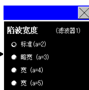
窗口画面 W-30020、W-30022、W-30024、W-30026、W-30028: 滤波器 1~5 陷波宽度
