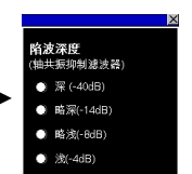
窗口画面 W-30033: 轴共振抑制滤波器 陷波深度
