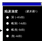
窗口画面 W-30021、W-30023、W-30025、W-30027、W-30029: 滤波器 1~5 陷波深度
