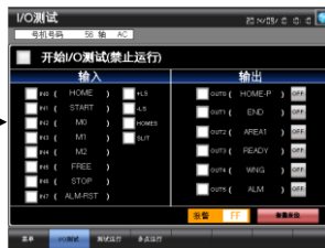
基本画面 B-31020: 测试 I/O 测试
